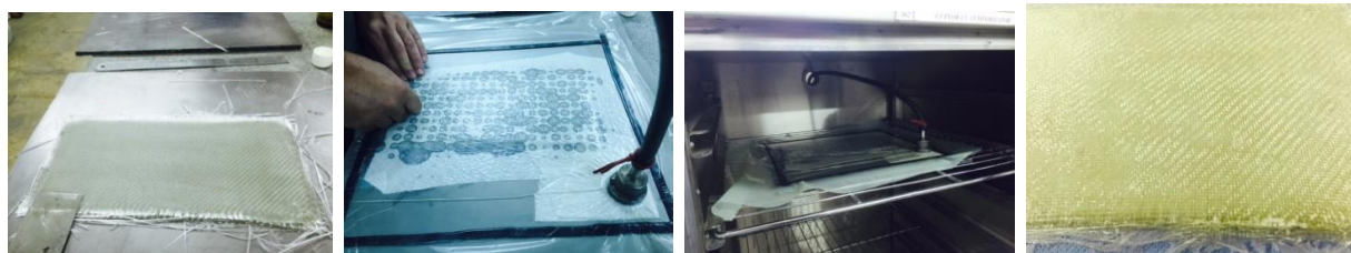
Fig. 2.1 Fabricarea epruvetelor din MC
